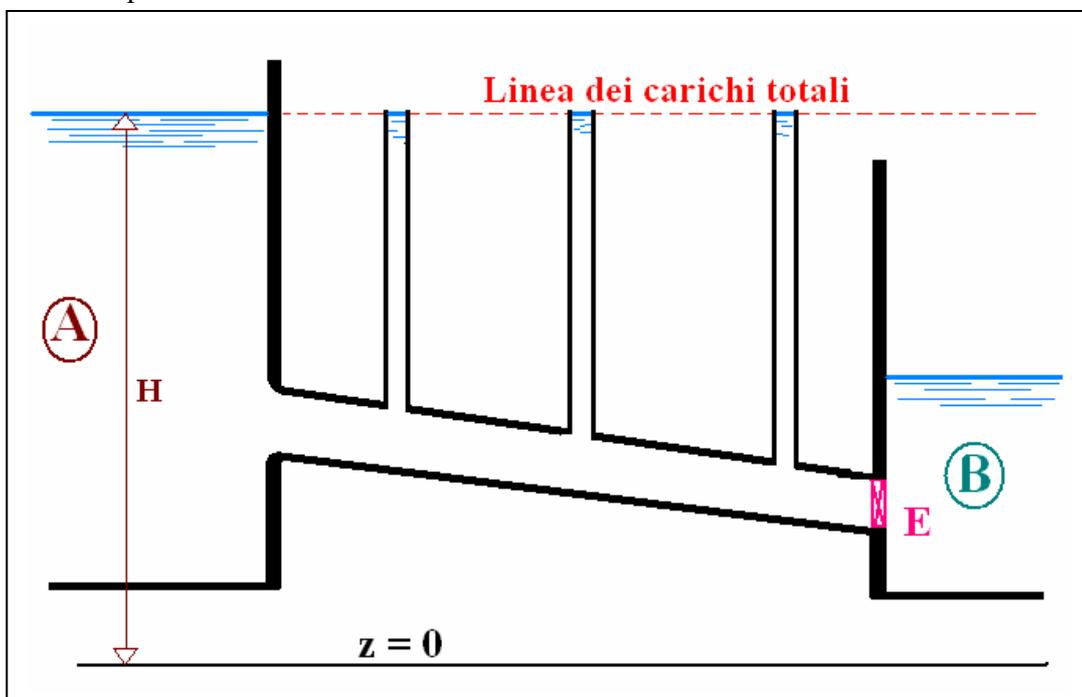
I due serbatoî sono collegati da una tubazione, alla quale sono applicati tre tubi verticali, i *piezòmetri*, che si innalzano sino ad una quota superiore alla quota dell'acqua contenuta nel serbatoio **A**. Per il *Principio dei vasi comunicanti*, che (vedi al Capitolo 2) potrebbe chiamarsi '*Principio di Erone*', quando la saracinesca **E** è chiusa, i due serbatoî non sono in comunicazione, ed il livello nei tre piezòmetri raggiunge la stessa altezza dell'acqua nel serbatoio **A**.
