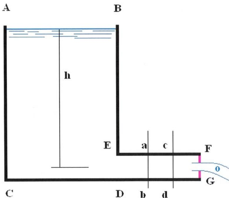
Se il tubo, nel punto **FG**, non avesse alcun restringimento, la velocità dell'acqua nel tubo sarebbe pari a  $\sqrt{h}$ , che è maggiore di  $\frac{\sqrt{h}}{n}$ .
