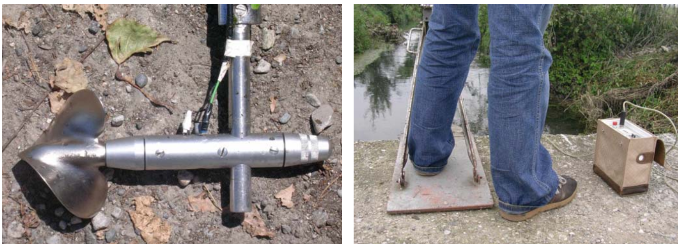
Fig. 49 – Strumentazione adottata dal CIC. A sinistra mulinello ad asse orizzontale. A destra il contatore e la staffa di supporto all'asta scorrevole per la misurazione dei livelli
