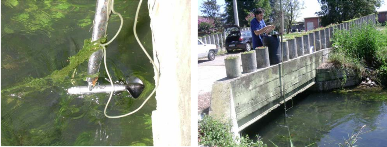
Fig. 54 – A sinistra: mulinello con elica ostruita da vegetazione acquatica. A destra: misurazione del 4/8/05 con ausilio di contenitore protettivo per piante da fiore
